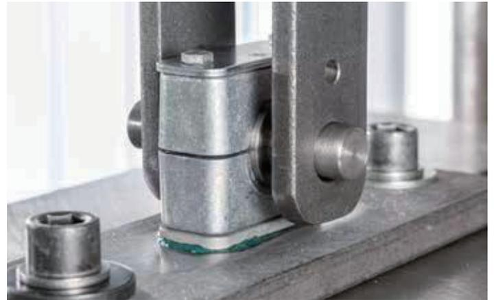
接着剤(CB420-50Eタイプ)使用STAUFFボンドプレート(SBPタイプ)の引張試験
