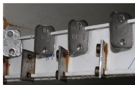
塩水噴霧試験結果 上列: ACTクランプ用金属部品 下列: 一般的なステンレス鋼
