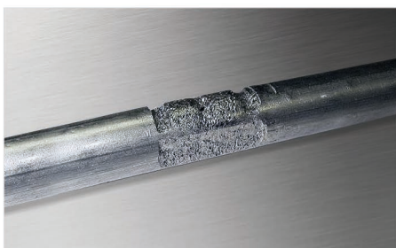
隙間腐食一例
